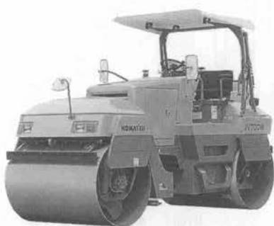
写真-7 コマツ JV 70 DW 2 振動ローラ (アーティキュレート式)
