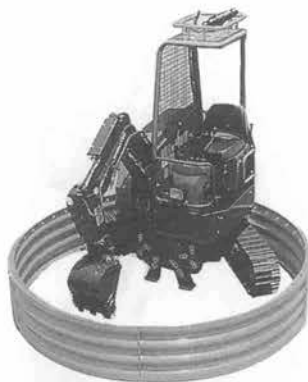
写真-5 コマツ ジオエース PG 15 SVE 電動深礎掘削機
