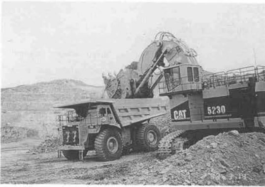
写真—3 18 m 3 ショベル (5230) による積込み
