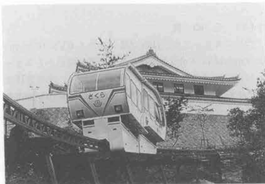
写真—2 スロープカー
