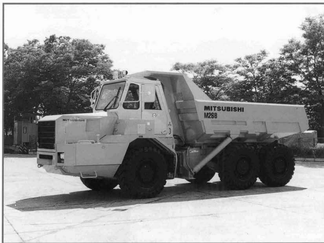
三菱アーティキュレートダンプトラック M26B (トンネル専用車) 新キャタビラー三菱株式会社
