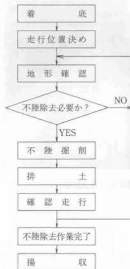
図-5 不陸除去作業手順
