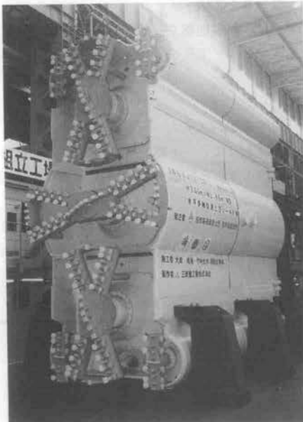
写真-1 MMST工法: DOT方式, 泥土圧式
