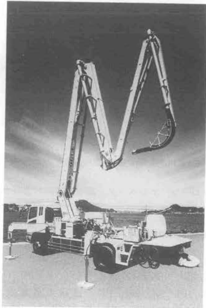
写真-9 三菱重工業 DC-SL 1100 BD-M 26 コンクリートポンプ車
