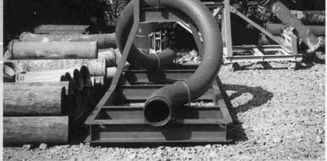
↑急勾配でコンクリートの流下速度をさげる スパイラル管
