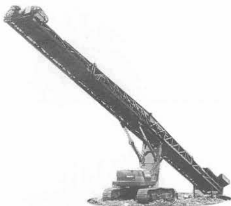
写真-4 コマツ BM 2014 C-1 自走式ベルトコンベヤ
