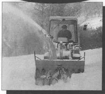
ロータリ除雪機で素早く雪を吹き飛ばす
