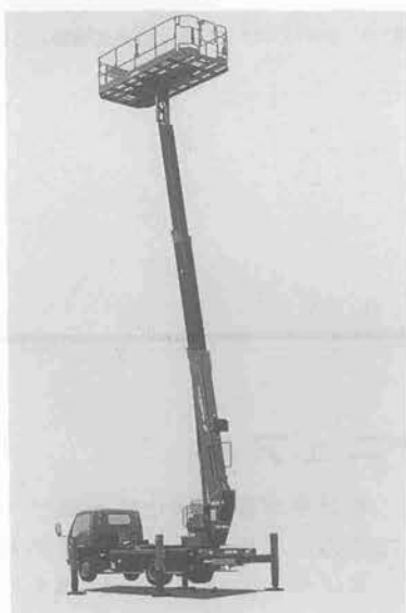
写真-6 アイチ TZ-15 A (スカイマスター) 高所作業車
