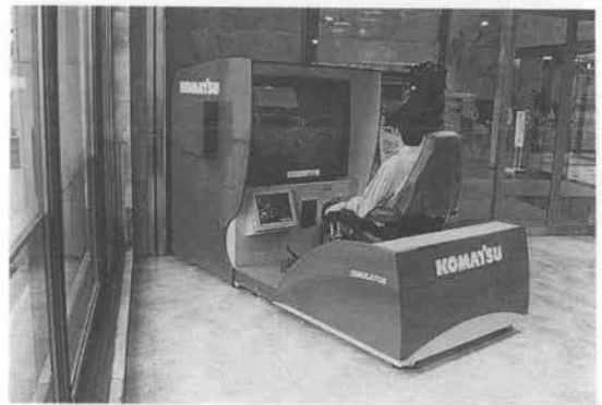
写真-4 運転訓練用建設シミュレータの開発
