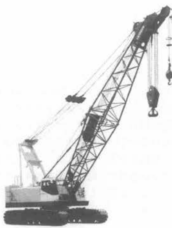
写真-5 日立 CX 900 クローラクレーン
