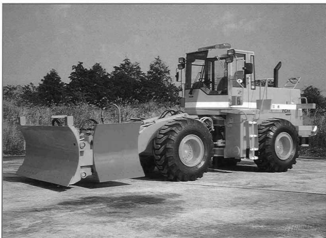
除雪ドーザ JD19形(19t級, サイドスライドアングリングブラウ付) 東洋運搬機株式会社
