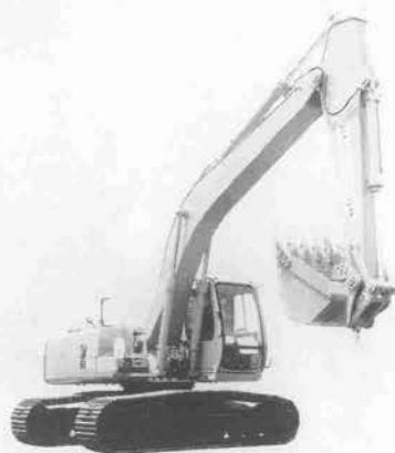
写真二 日立 EX 200-s 油圧ショベル・ML クレーン
