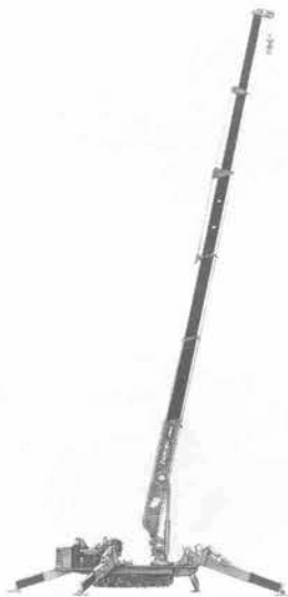
写真—6 古河ユニック UR-A 506 CL クローラクレーン
