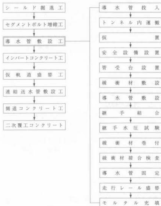
図—4 工事全体の施工手順
