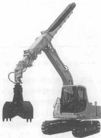
写真-1 コマツ PC 120 S-6 スーパーテレスコクラム・油圧ショベル
