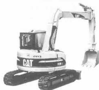
写真-3 CAT 313B SR「REGA」(上)と308B SR「REGA」(下)油圧ショベル(超小旋回型)
