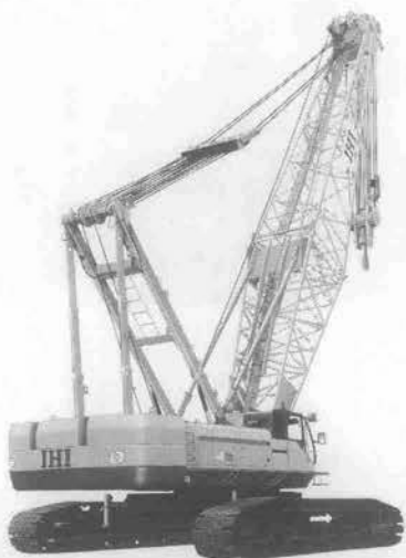
写真-6 石川島建機クローラクレーン
