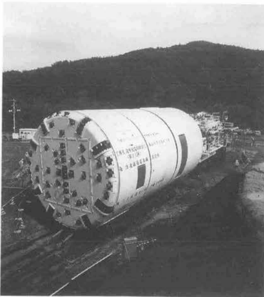
写真-1 TBM全体
