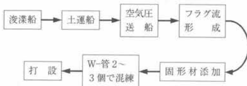
図-1 W-管工法のフロー
