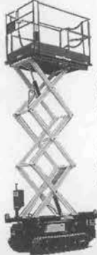
CL-610 作業高さ: 8.00m 作業台高さ: 6.00m
