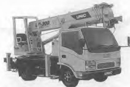
写真-6 古河ユニック UT 305 車両搭載型クレーン
