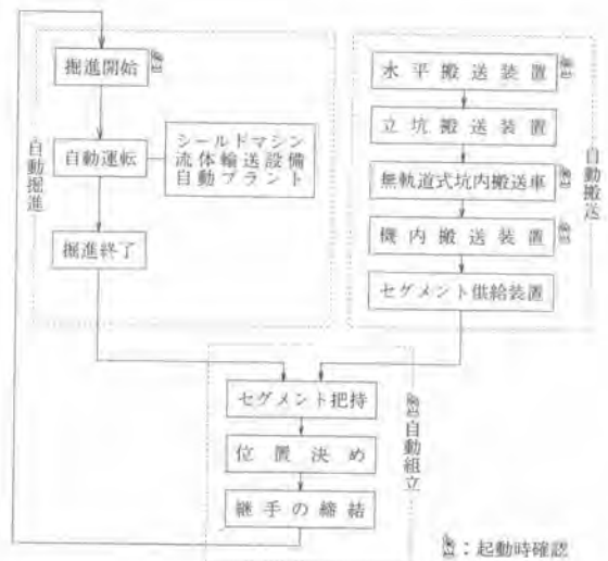
図-3 自動化施工フロー図
