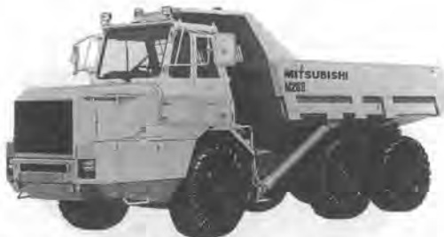
写真-3 三菱 M 26 B 重ダンプトラック (アーティキュレート式)
