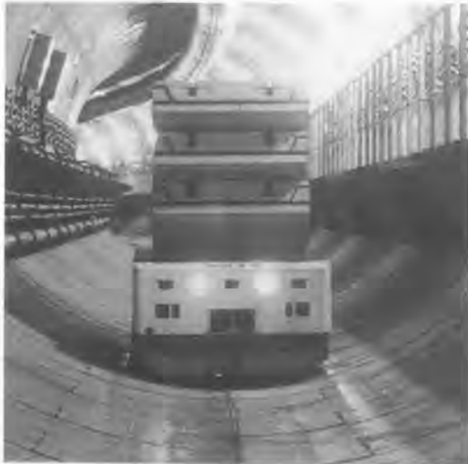
写真—2 坑内自動搬送車
