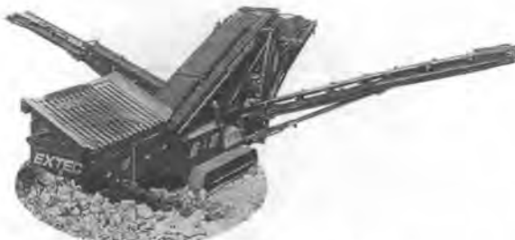
写真-7 日立 5000 TT 振動ふるい機 (自走式)
