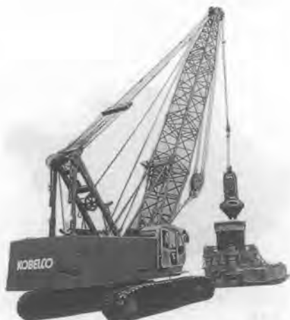
写真-5 神鋼 BM 700 HD クローラクレーン (全油圧式)
