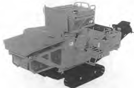
写真-8 コマツ「ガラバゴス・リテラ」BZ 120-1 自走式土質改良機
