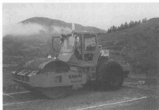
写真-2 GPSの受信ができる振動ローラ(屋根にアンテナが見える)
