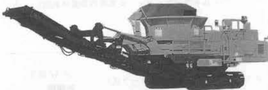
写真-6 コマツ「ガラバゴス・リフォーレ」BR 200 T -1 木材破砕機
