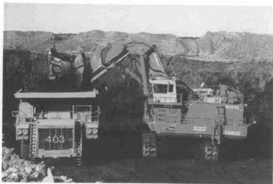
写真—1 カナダ鉱山で稼働中のEX5500
