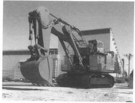
写真—2 テスト中の EX 5500 のバックホウ
