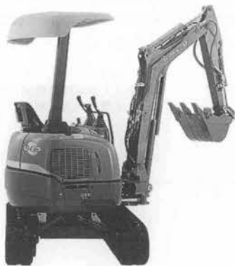
写真-1 クボタ U-15 小型油圧ショベル(後方小旋回型)
