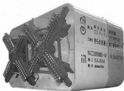
矩形揺動型シールド (H4.98m×W7.81m)
