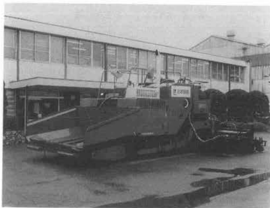
写真-9 新潟鐵工所 NTP 60-TVTM 「タックペーバ」アスファルトフィニッシャ（乳剤散布装置搭載型）
