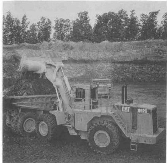
写真-3 1本リフトアーム
