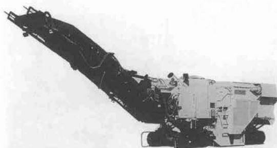
写真—10 酒井重工業 ER 570 CF 路面掘削機 (クローラ式)
