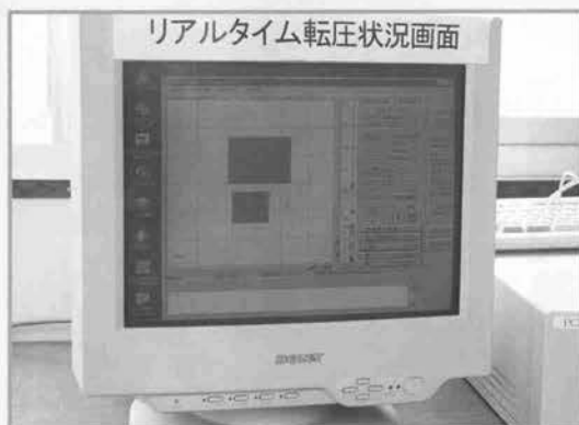
↑ 事務所側機器により転圧状況をモニターできる
