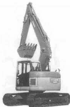
写真—4 コマツ PC 128 US 2 「アバンセ NRO」油圧ショベル（後方小旋回型）
