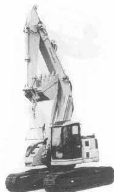
写真—5 住友建機 SH 215 U-2「スピンエース」油圧ショベル（クレーン付）
