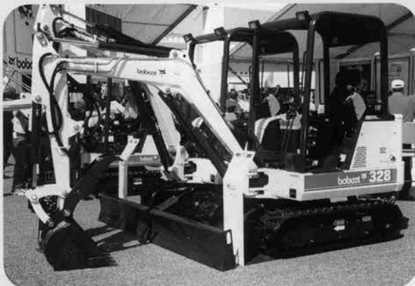
⇩ボブキャットのオペレーター保護構造型 キャノピ付きミニショベル
