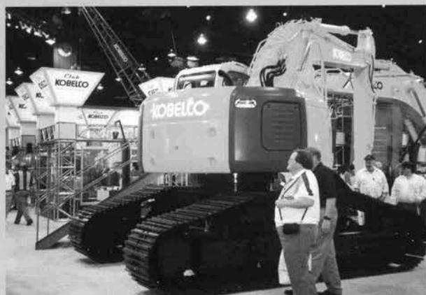
↑コベルコの23t級森林用後方小旋回型油圧 ショベル
