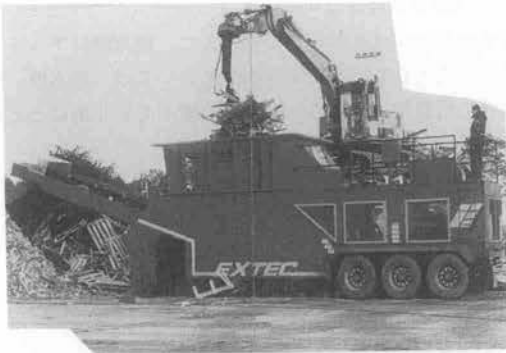
写真-8 日立 3600 S 建設廃材破砕機 (被けん引式)
