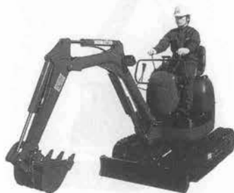
写真—2 コマツ PC10MR -1 「アバンセ NRO」 小型油圧ショベル
