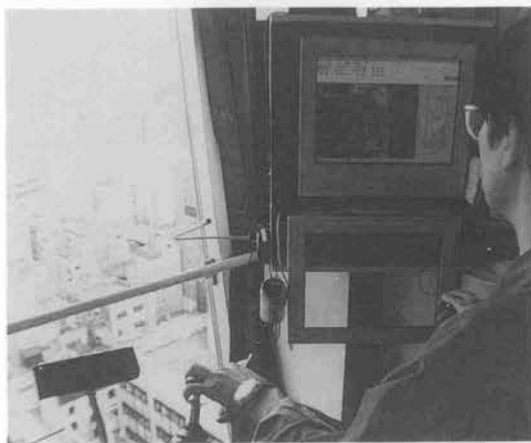
写真-1 クレーン運転室のパソコン
