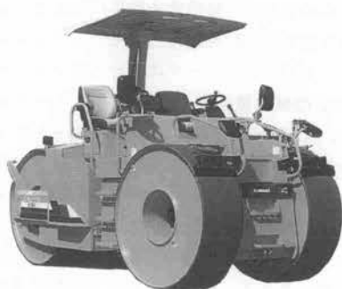
写真-9 川崎重工業「オーセント」K 12 Aロードローラ (マカダム型)
