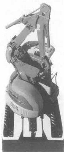
写真1 コマツ「アバンセ NRO」PC 38 UU 3 超小旋回式小型油圧ショベル
