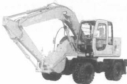
写真-5 日立建機 EX 125 WD-5 油圧ショベル (ホイール式)
