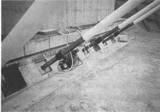
写真—9 グラウンドアンカ張力計測状況
