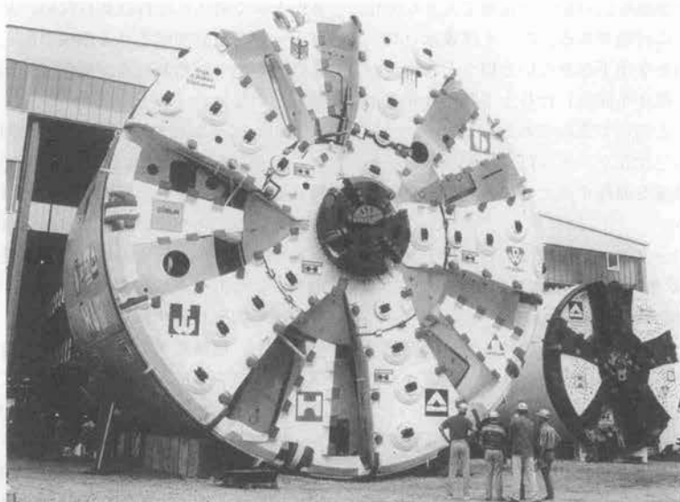
写真—1 ヘレンケニヒト (Herrenknecht) 社のエルベトンネル用シールドマシン (現在世界最大) と小さなベルリンの地下鉄トンネル用シールドマシン (右)
