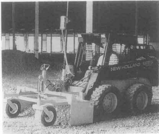
写真-1 レーザ誘導出来型システム
