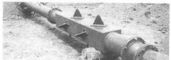
写真—22 LMP 型ラインミキサ (φ300) (攪拌羽は撮影のため外側に設置している)
