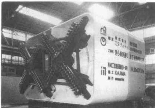
写真一 本工法のシールドマシン
