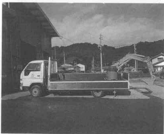
写真—4 フィンガー搭載のトラッククレーン
