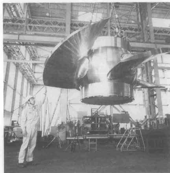
写真-2 排水機場用立軸可動翼軸流ポンプ(口径3,600 mm)のプロペラ
