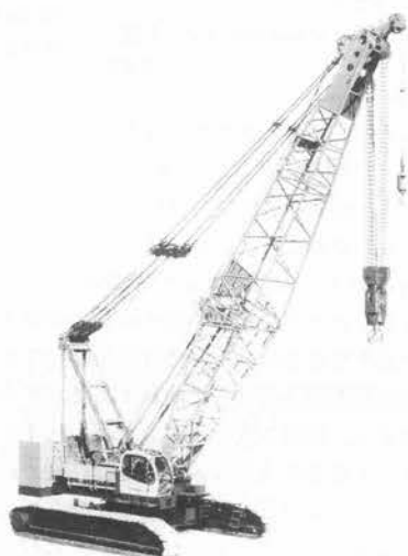
写真-7 神鋼「マスターテック」7200クローラクレーン (全油圧式)
