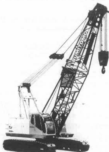
写真-6 住友建機 SC 500- 3 クローラクレーン (全油圧式)
