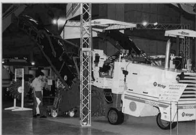
⇧舗装再生機械
