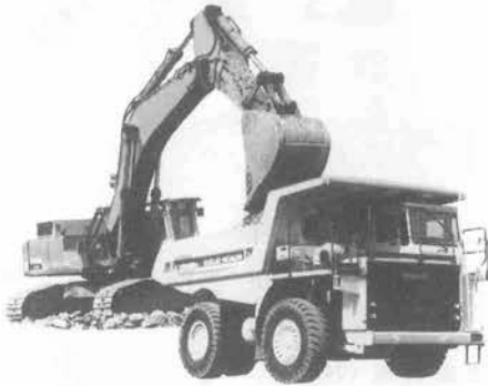
写真-2 日立建機「ユークリッド日立」R40C重ダンプトラック
