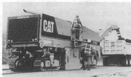
写真—13 CAT PM-565 B 路面切削機 (クローラ式)
