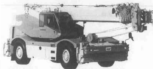
写真-11 コマツ「WING 500 パワーズームジブ仕様車」 LW 500-12 ラフテレーンクレーン
