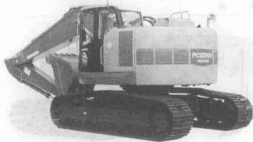
写真-1 コマツ「アバンセ NRO」PC228 US-2油圧ショベル(後方小旋回型)
