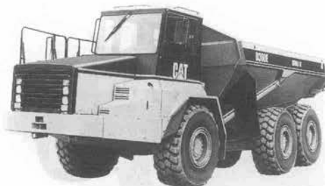
写真一七 CAT 300 E SERIES II 重ダンプトラック (アーティキュレート式)
