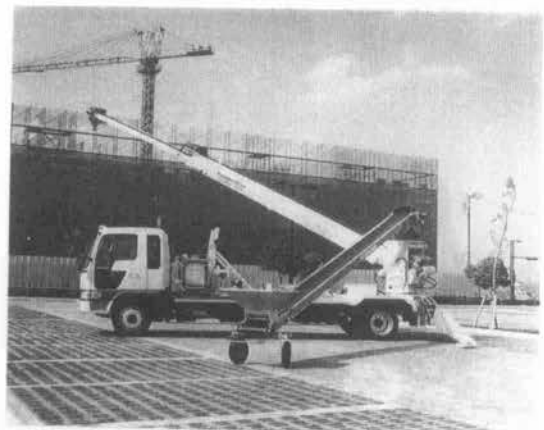
写真一八 トーメン建機「テレベルト」TB 50 ベルトコンベヤ (車両搭載式)
