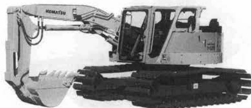
写真-4 コマツ「スーパージオ」PG 75 -1 油圧ショベル (超低車高型)
