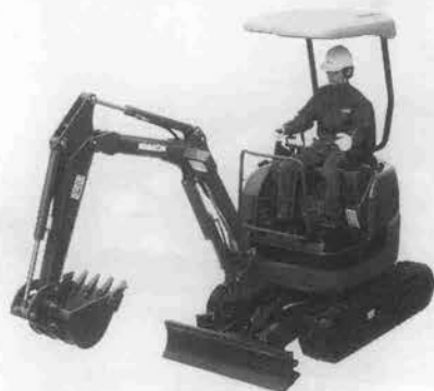
写真—5 コマツ「アバンセNRO」PC15MR -1 小型油圧ショベル（後方小旋回型）
