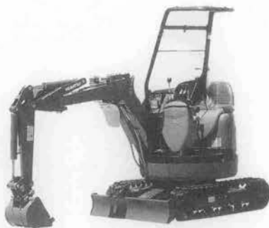
写真-5 コマツ「アンバセ NRO」PC 10 UU 3 小型油圧ショベル (超小旋回型)
