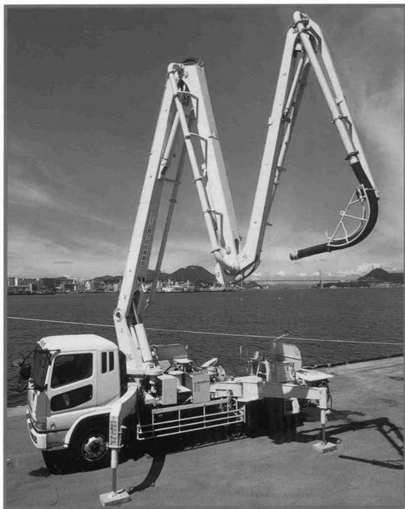
三菱コンクリートポンプ車 ダイアクリート SL1100 BD-M26 三菱重工業株式会社
