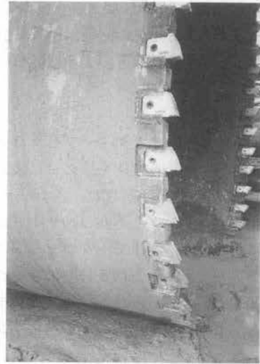
写真-2 タンデム型カッタビット装置状況
