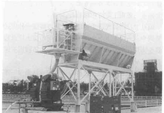
写真-3 セメントミルク製造装置
