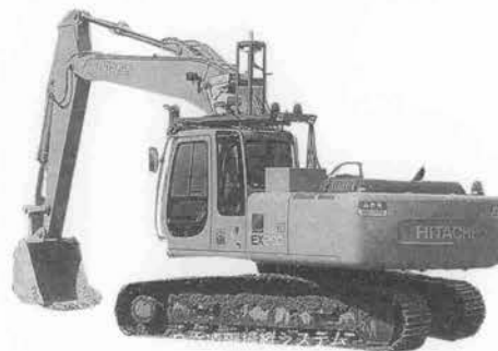
写真-6 日立 油圧ショベル・遠隔操縦システム (映像伝送付き無線操縦機)
