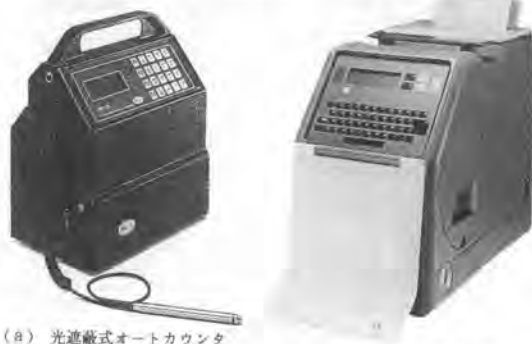
(b) フィルタ差圧検式清浄度モニター
