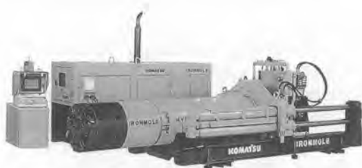
写真-12 コマツ「アイアンモール」TP 95 S 2 小口径管推進機
