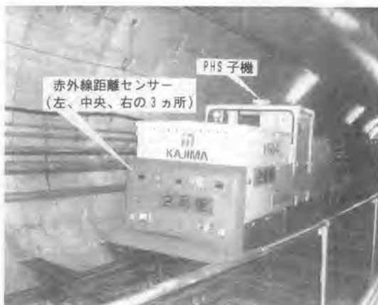
写真-3 PHS 子機を取付けたバッテリー機関車
