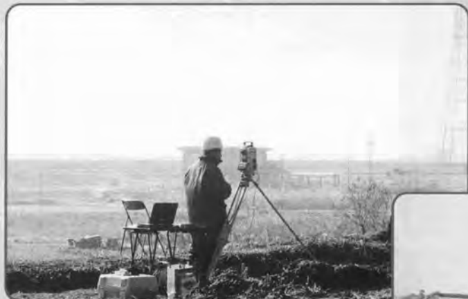
⇩ 情報化施工制御機器 （3次元マシンコントロールシステム用の制御ステーション側）
