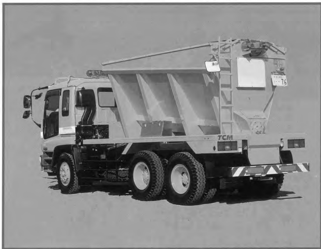
凍結防止剤散布車 JS80型 ホッパ蓋自動開閉装置付 TCM株式会社
