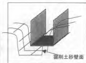
図-1 掘削面を保護する函体
