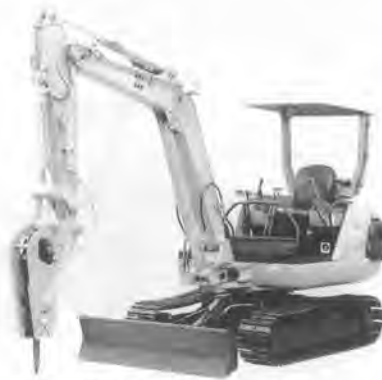
写真-11 日立 HSB 22 油圧ブレーカ (小型油圧ショベルに装着)
