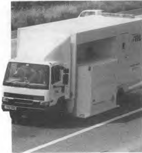
写真-1 TRLの新型タイヤ/道路騒音調査車, Triton
