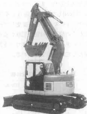
写真—4 コマツ「アバンセ NRO」PC128 UU-2E 油圧ショベル (超小旋回型)
