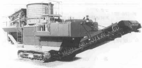
写真—9 日立 SR-P 1200 自走式土質改良機
