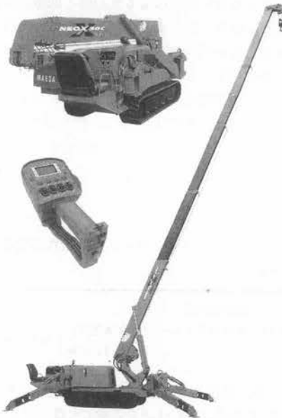
写真—6 前田製作所 MC-305 CW クローラクレーン
