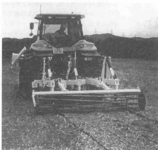
写真-1 ハンプブレーカ作業
