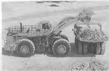
ホイールローダからダンプトラックへ積替え
