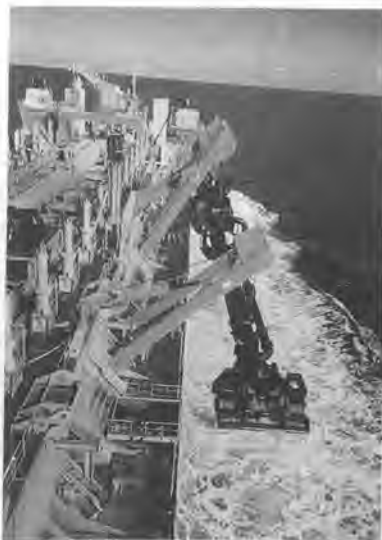
写真-2 サクションパイプ
