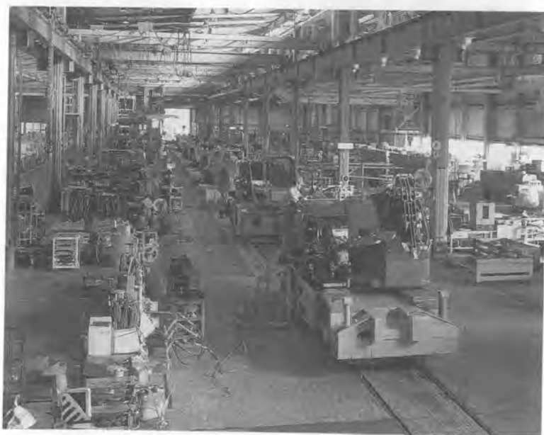
写真-6 車両組立てライン 小ロット混合生産方式により90機種以上の機械を同一ラインで生産しています。
