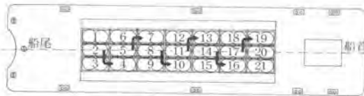
図-11 位置決めおよび攪拌混合順序
