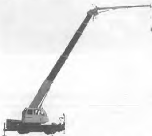
写真-5 コベルコ建機「モバイルタワー 300 TT」RK 120 ホイールクレーン
