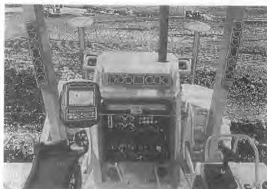
写真—6 Trimblies 社の GPS 出来形管理システム
