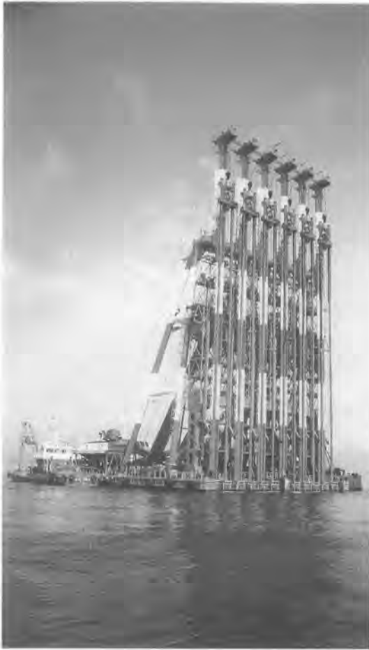
写真-1 12連装のサンドドレーン船
