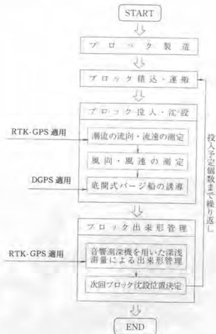
図-5 ブロック沈設の施工手順
