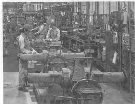
写真-4 アクスル組立てライン 徹底した品質管理の中で機械を支える車軸（アクスル）を組立てています。
