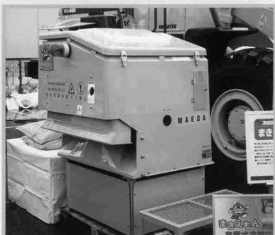
↑ FRP製の固定式凍結防止剤散布装置
