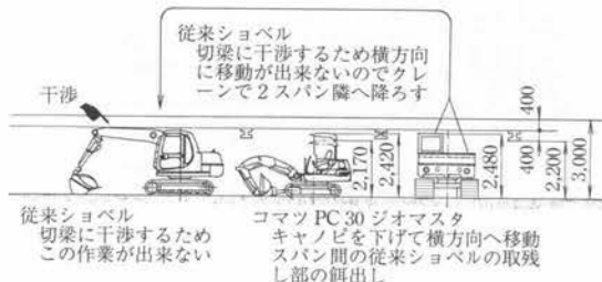
図-10 当初計画 従来ショベルとコマツ PC 30 の共同作業
