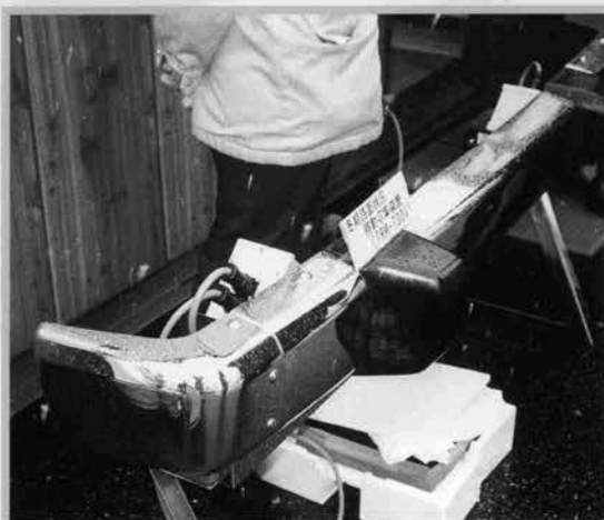
↑路面状況検知センサー
