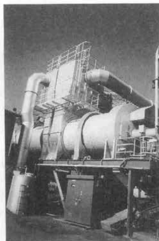
写真—11 新潟鐵工所「エコバード」ECOVARD 1000 アスファルトプラント・ドライヤ
