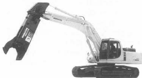
写真-2 コマツ PC 300 LC-6Z 「ダイナシャー」油圧ショベル (解体仕様)
