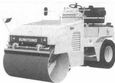
写真-9 住友建機 HW 41 VW -3 振動ローラ (コンバインド型)
