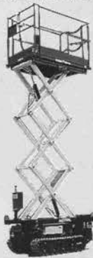
CL-610 作業高さ：8.00m 作業台高さ：6.00m
