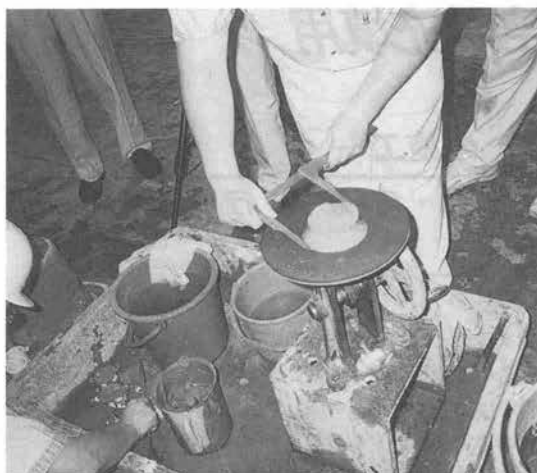
写真-1 テーブルフロー試験状況
