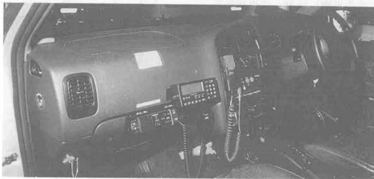
写真-2 「雪水管理システム」の車載装置（無線機、GPS アンテナ、操作機）
