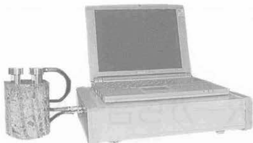
写真-2 超音波探査装置
