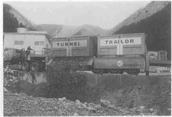
写真-15 トンネルトレーラ (試験施工：兵坂トンネル)
