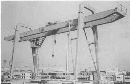
写真-3 橋形クレーン
