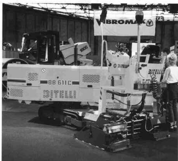
↑BITLLI社 小型アスファルトフィニッシャ (ホッパーが縦・横取自在)
