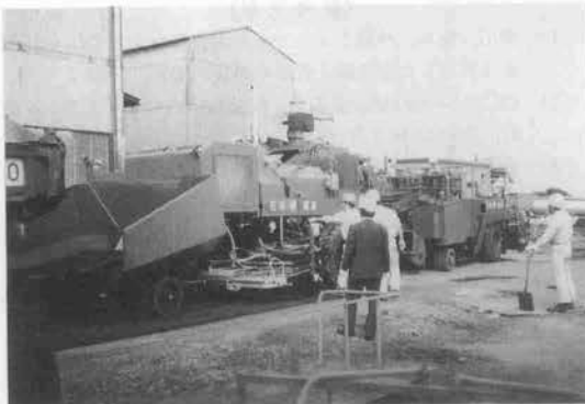
写真—11 常温式路上表層再生機
