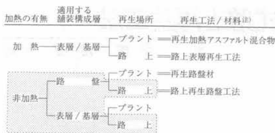
図-1 アスファルト舗装の再生工法の分類
