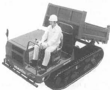
写真-3 コマツ CD 30 -1 不整地運搬車ゴムクローラ
