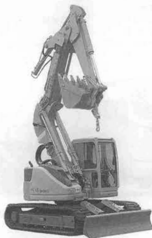
写真一 住友建機「spin ACE」SH 135 XU 油圧ショベル (超小旋回型・クレーン付)
