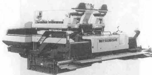
写真一九 三菱 MF 61 D アスファルトフィニッシャ (クローラ式)
