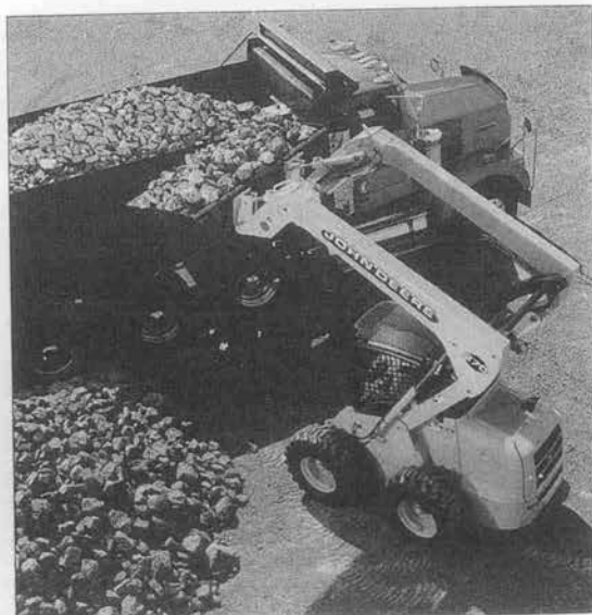
写真-1 John Deere 270 シリーズの、2 速ラジアル・ピストン油圧モータにより 12 mph の最高速度まで加速できる
