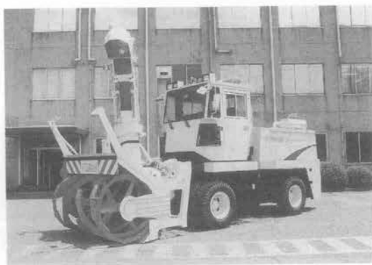
写真-5 道路用除雪車(NR280)
