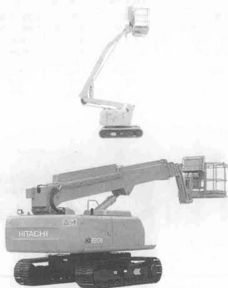
写真—5 日立建機 HX 64 B (上) と HX 220 B (下) 高所作業車 (クローラ式)
