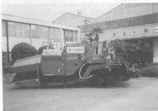
写真-7 透水・排水性舗装対応、乳剤散布装置搭載型アスファルトフィニッシャ(タッグペーバ)
