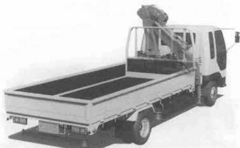
写真-6 タダノ「Yo-Ko」ZC 304 トラック搭載形クレーン
