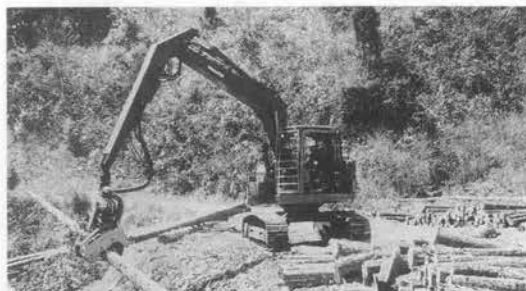
写真-3 コマツアバンセ NRO PC 138 US-2 油圧ショベル林業仕様車
