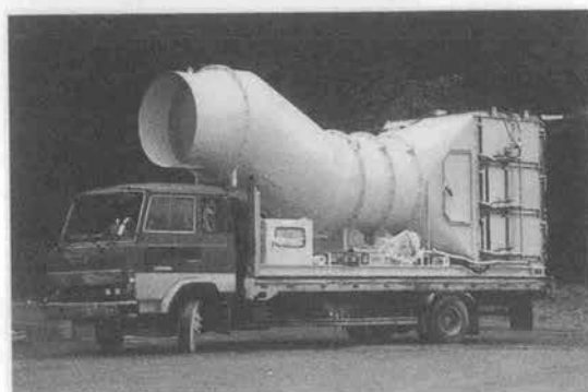
写真-7 松下電器産業「クリーンジェット」FY-20 TKE 電器集塵機 (トンネル掘削工専用)
