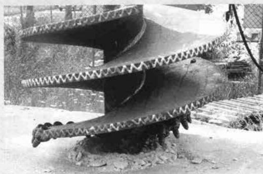
↑マルチドリル工法掘削機 ソイルメック モデル R-10J ロックオーガー工法 ロックオーガービットによる鉄筋コンクリート削孔
