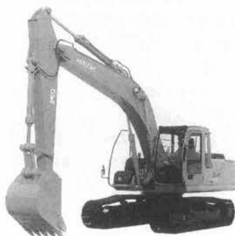
写真二 日立建機「ZAXIS」ZX 200 油圧ショベル
