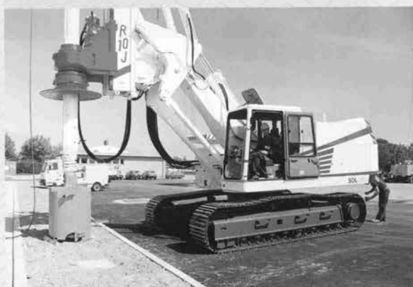
↑マルチドリル工法掘削機 ソイルメック モデル R-10J アースドリル工法姿図 ドリリングバケット装着
