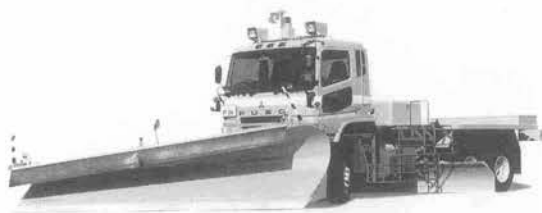
写真—10 三菱自動車工業「スーパーグレート」KL-FW 50 MNZ (3改) /6×6 除雪トラック
