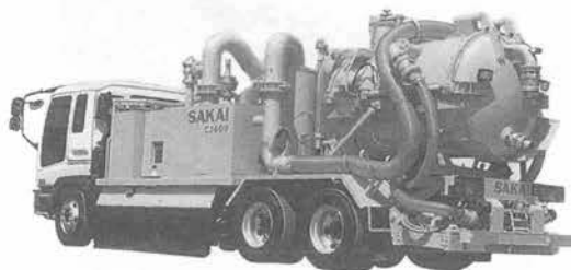
写真—9 酒井重工業 CJ 400 -1 排水性舗装機能回復車
