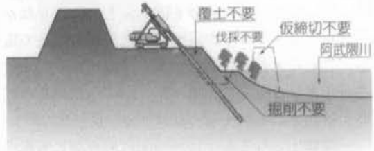
図-3 TRD工法施工イメージ
