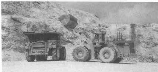
写真-4 CAT 789 C 重ダンプトラック
