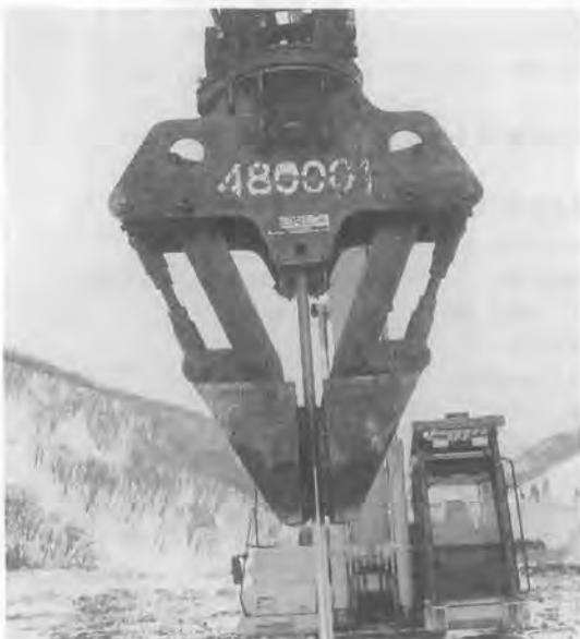
写真-4 全回転クランプによる丁張り設置
