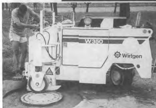
マンホールの周りも簡単に切削できます
