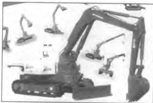
写真—2 RA 30 (ラマンチャ：非搭乗ラジコンマルチ建機)
