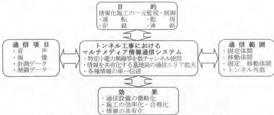
図-1 トンネル工事におけるマルチメディア情報通信システム概念図
