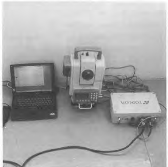
写真-3 自動追尾トータルステーション
