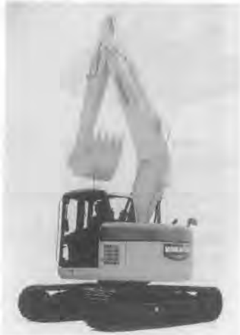
写真-5 コマツ「アバンセ NRO」PC 128 US 2 油圧ショベル (後方超小旋回型)
