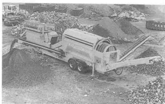
写真-8 コマツ「ガラバゴス」スクリーン BM 798 F -1 選別機 (被牽引式)
