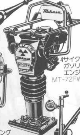
タンピング ランマー 4サイクル ガソリン エンジン
