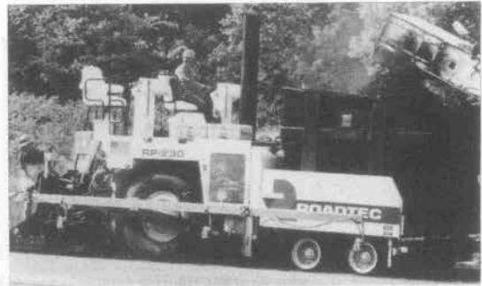
写真—1 Roadtec社のRP-230, 234馬力, ゴム輪フィニッシャー (standard fume extraction system), 油圧で上昇とチルト (tilt) されるオーガ, 超音波フィードコントロール (sonar feed controller) 及び機械式または超音波式オートマチックスロープコントロールを特徴としている。
