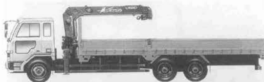
写真-7 古河ユニック UR-V 504 PK (フック自動連動・格納式) トラック搭載型クレーン
