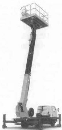
写真-6 タダノ「モバイルローラ」AT-100 S 高所作業車
