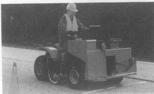
写真—2 ATV型自動車に搭載した International Cybernetics Profiler
