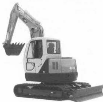
写真-2 石川島建機 80 NX 油圧ショベル (後方超小旋回型)
