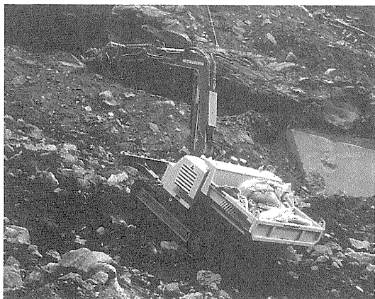
写真—1 非塔乗形機械把持&amp;ダンプ機能
