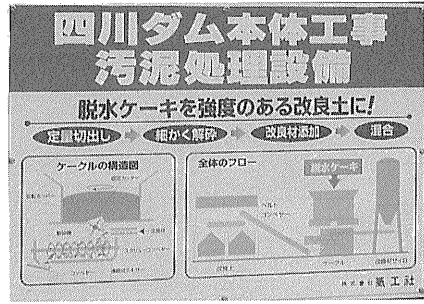
写真-3 汚泥処理設備 フローシート
