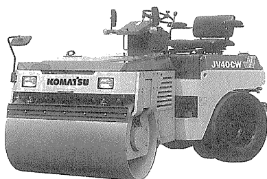
写真-8 コマツ JV 40 CW -5 振動ローラ (コンバインド型)
