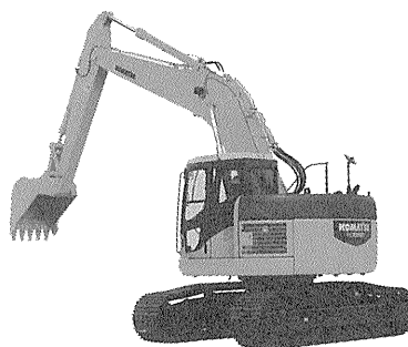
写真—2 コマツ「アバンセ NRO」PC 228 US -3 油圧ショベル (後方超小旋回型)
