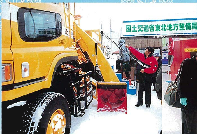
↑国土交通省参考出品 運搬排雪車 (横にロータリ装置とリフトコンベアが見える)
