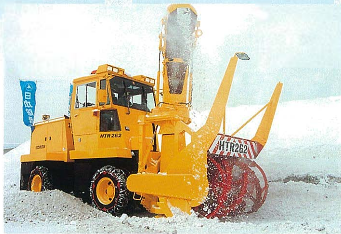
↑日本除雪機製作所 HTR262ロータリ除雪車
