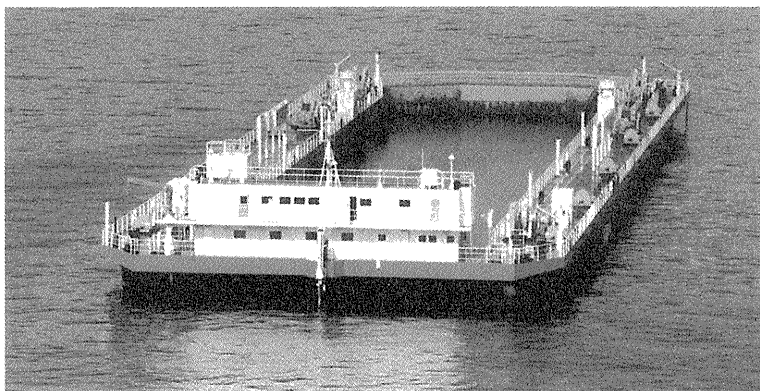
写真—1 汚濁防止柵(船)概観
