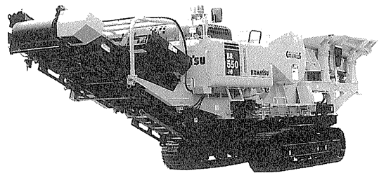
写真-8 コマツ「ガラバゴス」BR 550 JG-1 自走式生産破砕機
