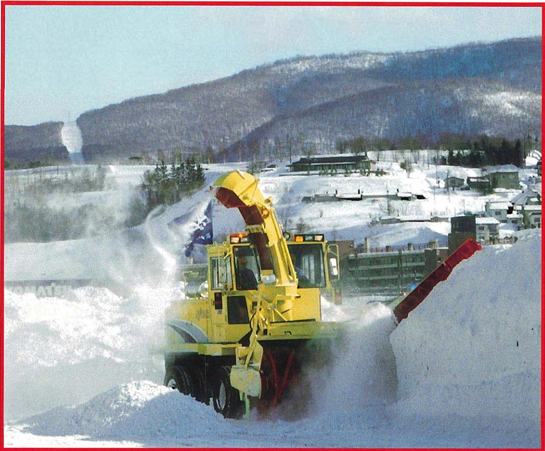
ニイガタロータリ除雪車 NR656 高雪堤処理装置付 株式会社新潟鐵工所
