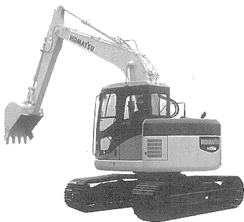
写真—1 後端小旋回油圧ショベルの一例 コマツ PC 138 US
