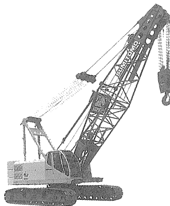
写真-7 住友重機械建機クレーン SC 700-5 クロラクレーン
