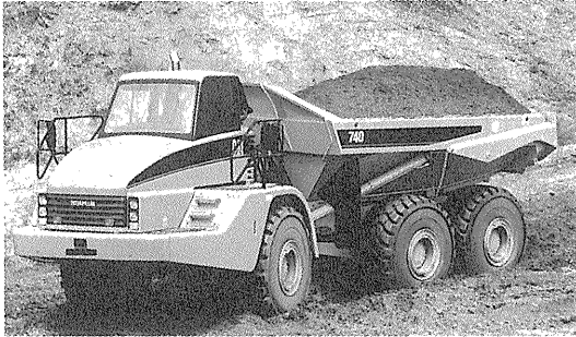
写真—4 CAT 740 重ダンプトラック (アーティキュレート式)
