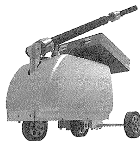
写真—9 コマツ路面形状測定機(手押し式)「ハンディするする」
