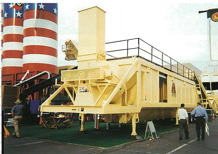
↑可搬式コンクリートプラント
