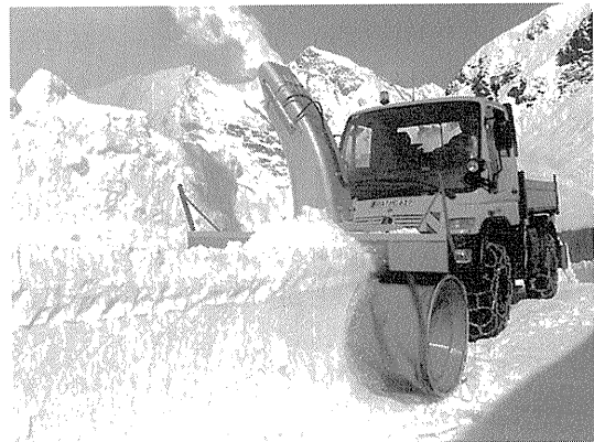
写真—10 スノーカッターと凍結防止剤散布機のコンビネーション
