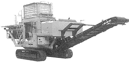
写真—6 日立建機 SR-G 2000 土質改良機 (自走式)
