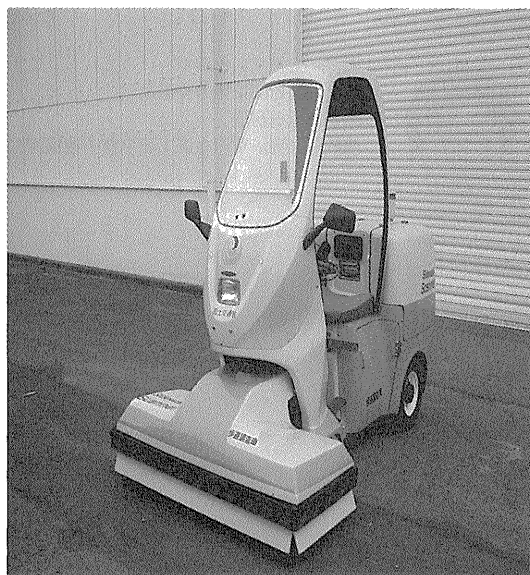
写真-2 歩道下空洞探査車
