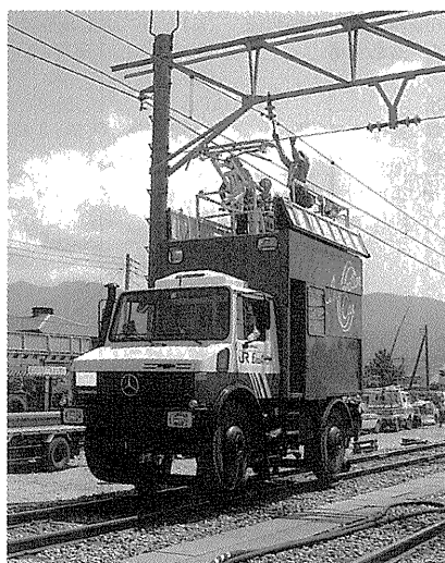
写真-6 ヤナセ U 400 ZA 多目的作業車 (狭軌用軌陸車)
