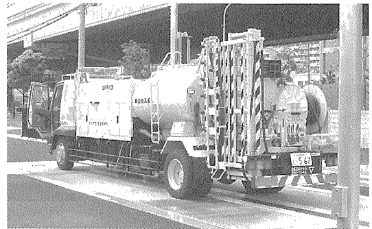
写真-8 透光性遮音壁清掃車全景
