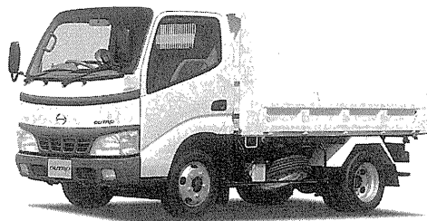
写真二 日野自動車 GE-RZU 300 M-TQMMK 3 (改) 小型ダンプトラック (LPG車)
