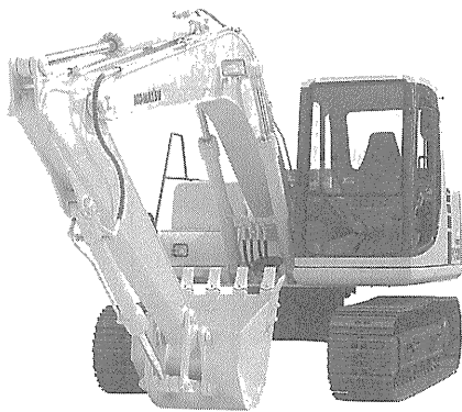
写真—1 コマツ「ニューアバンセ」PC 120- 6 油圧ショベル
