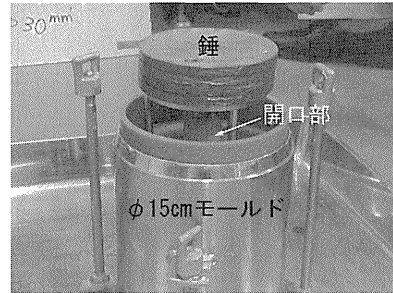
写真—5 押抜きせん断試験
