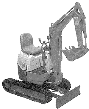
写真-3 ヤンマー VIO 10 -2 ミニショベル(後方超小旋回形)
