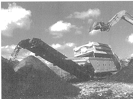
写真—6 メッツォ・ミネラルズ・ジャパン ST 171 振動ふるい機（自走式）
