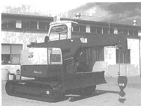
写真-5 長野工業 CX-29 2 クローラクレーン (地下仕様車)
