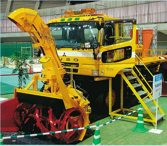
↑多機能除雪車(ロータリ除雪装置付)
