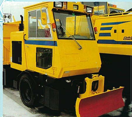
↑薬剤散布装置付マルチ除雪車(車両幅1.3m) ↑
