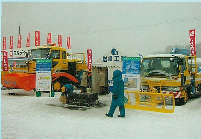
↑バケットローダ(2.0m 3 )型とプラウ付除雪トラック
