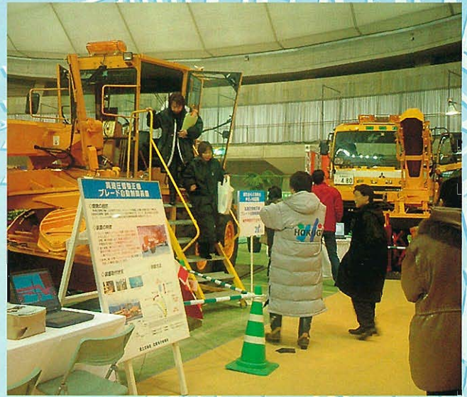
↑高速圧雪整正機(ブレード自動制御システム付)
