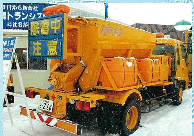
↑ 凍結防止剤散布車 (2.5m級)
