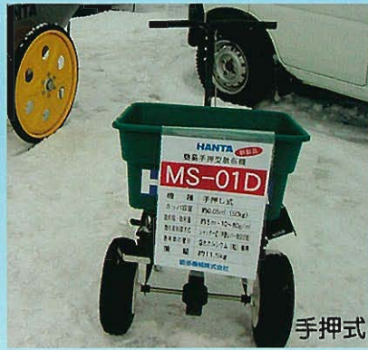
↻ ↑ 凍結防止剤散布装置 ↓ ↻
