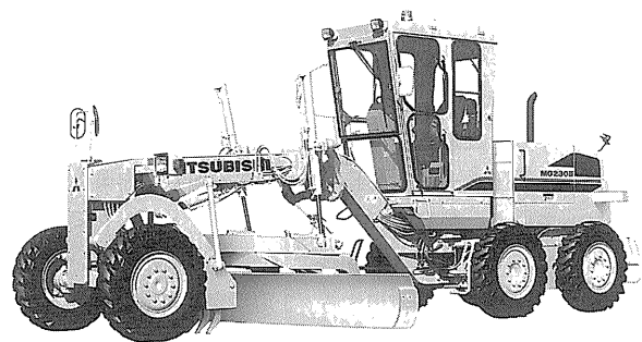
写真一九 新キャタピラー三菱 MG 230 II モータグレーダ
