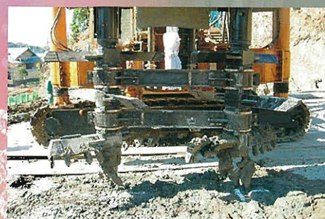
攪拌翼(翼径1.2m×2軸、エジェクター吐出方式) ↑
