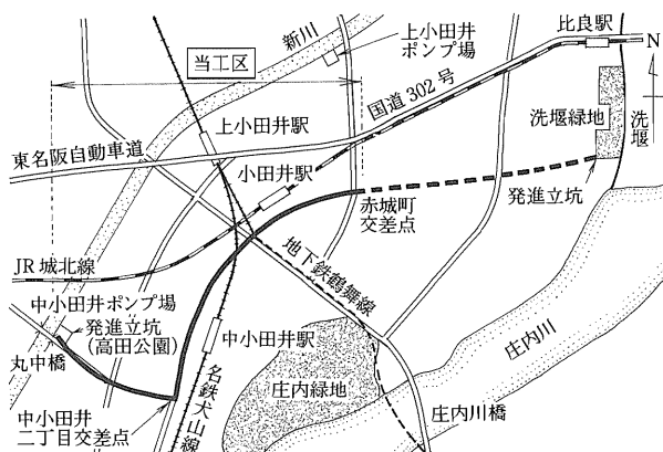
図-1 小田井貯留管計画平面図
