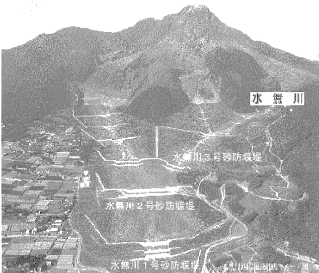
図-1 砂防施設設計画図
