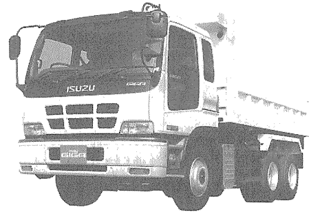
写真一六 いすゞ自動車「GIGA 20」KL-CXZ 51 K 4 (6×4・272 kW) ダンプトラック
