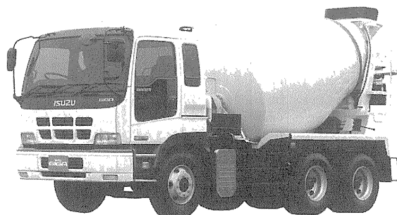
写真-10 いすゞ自動車「GIGA 20」KL-CXZ 51 K 4 (6×4・272 kW) トラックミキサ
