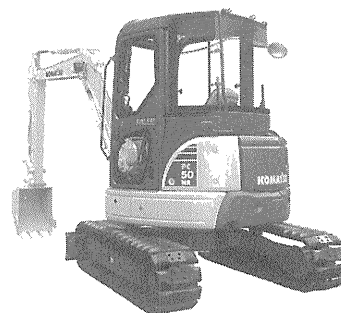
写真-3 コマツ「GALEO」PC 30 MR 2 (上) と PC 50 MR 2 (下) ミニショベル (後方超小旋回形)
