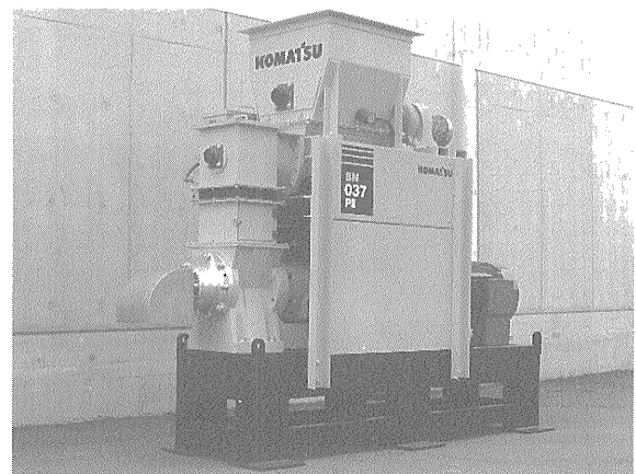
写真1 木材膨軟化処理機の外観
