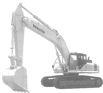
写真-2 コマツ「GALEO」PC 450 2 油圧ショベル
