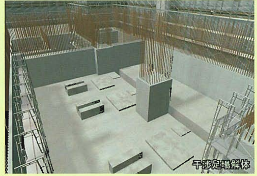
↑②搬入機器と干渉する足場の解体
