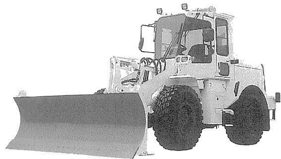
写真-11 川崎重工業「AUTHENT」65 DV 除雪ドーザ
