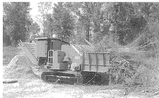
写真—8 コベルコ建機「ハスキーグラインダ」H 3045 T 木材破砕機
