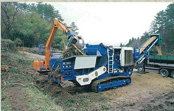
⇩長尺の伐採材を現場内にて粉碎作業中
